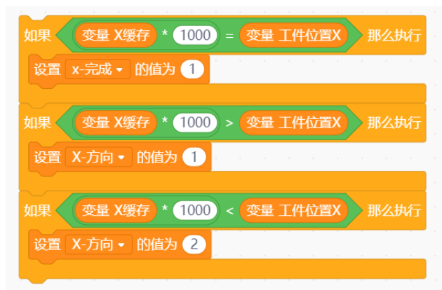
图-94 判断数据变化，确定步进电机运行方向。
